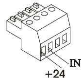
Интерфейс ЕРО является цепью безопасного сверхнизкого напряжения (SELV - Safety Extra Low Voltage). Подключайте его только к цепям SELV. Интерфейс ЕРО осуществляет контроль над цепями без установленного потенциала. Такие замыкающие цепи могут быть выполнены при помощи выключателя или реле, надлежащим образом изолированного от сети. Во избежание повреждения ИБП не подключайте интерфейс ЕРО к любой цепи, отличной от цепи с замыкающим контактом.
