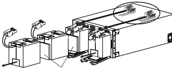
Потяните за шнуры отсоединения батарей, прикрепленные к разъемам батареи. НЕ ТЯНИТЕ за провода для отсоединения батарей.
