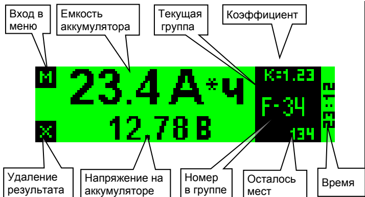
Рис. 2. Дисплей прибора в режиме записи результата по умолчанию
